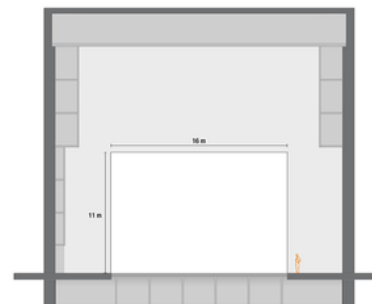
AUDITORIO Y PALACIO DE CONGRESOS EL BATEL SALA A. Plano de embocadura del escenario
